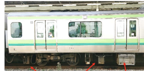
軌道変位モニタリング装置
